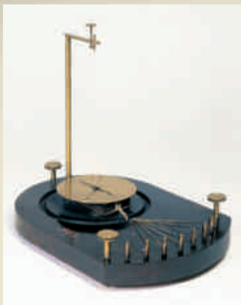
Leopoldo Nobili, Galvanometro differenziale, 1826. Firenze, Istituto e Museo di Storia della Scienza
